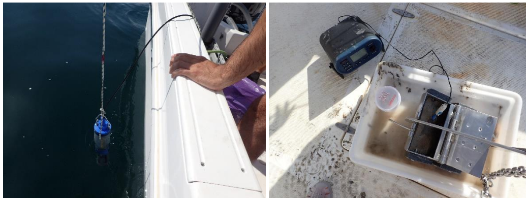
Figura 2.4. Sonda multiparamétrica Eureka Manta 2. Medida in situ del potencial REDOX.
