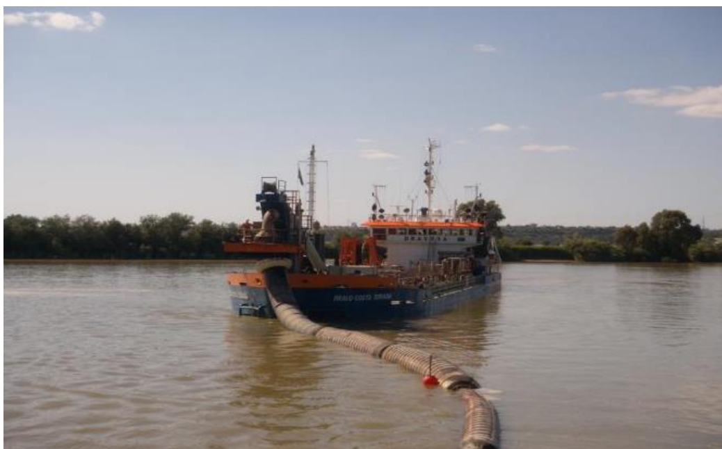
Figura 2.9. Draga Dravo Costa Dourada empleada en los dragados de mantenimiento.
