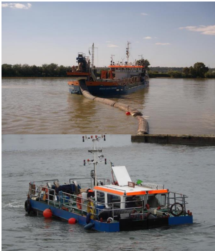
Figura 2.11. Dragas empleadas en los dragados de mantenimiento en el tramo de La Isleta. La Dravo Costa Dourada arriba, la Odín abajo.
