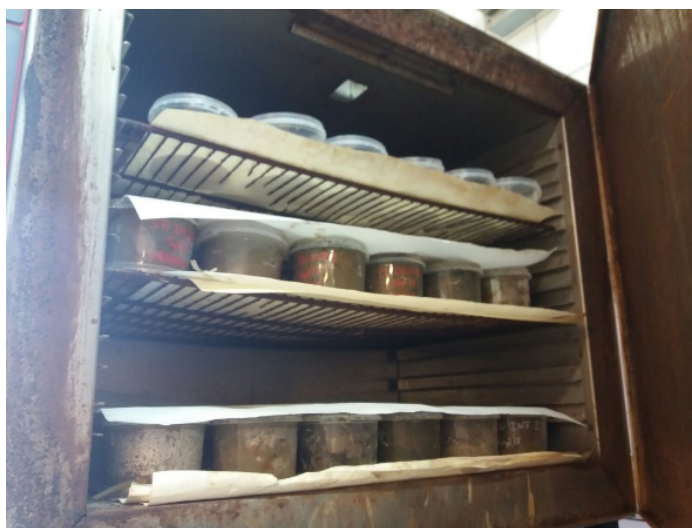
Figura 2.5 Proceso de secado de muestras de sedimento para la posterior medida de parámetros físico-químicos.
