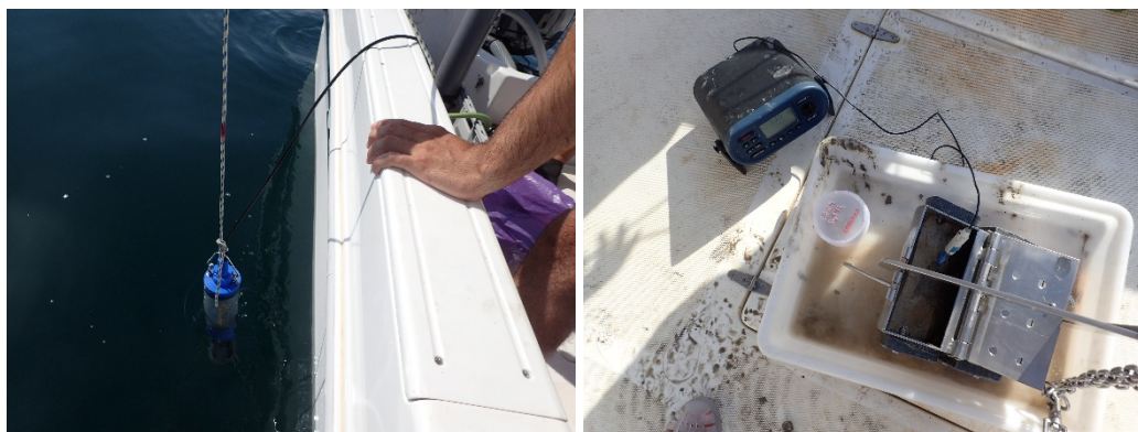
Figura 2.4. Sonda multiparamétrica Eureka Manta 2. Medida in situ del potencial REDOX.
