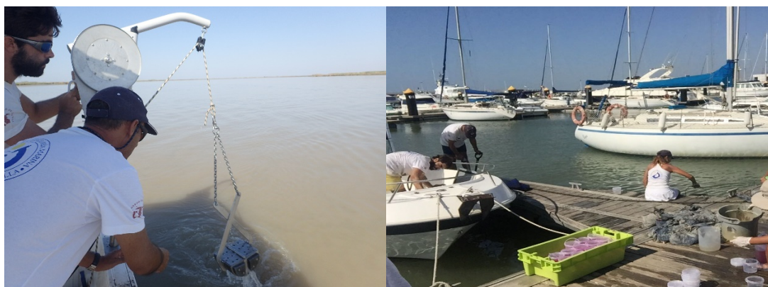
Figura 2.2. Embarcación LBM III. Draga Van Veen. Muestras embolsadas para traslado a puerto. Proceso de tamizado en el puerto.
